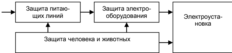
Рисунок 1. Система защит производственного помещения
